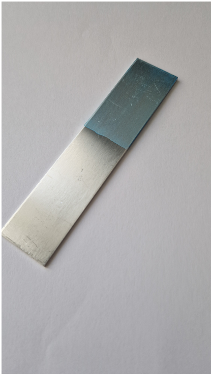
Bild 1 Einfache Applikation: Vor der Verklebung mit Strukturklebstoffen wird eine dünne Schicht von weniger als 20 µm Primer aufgetragen. © Bodo Möller Chemie GmbH
