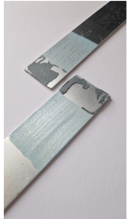
Bild 3 Für mehr Nachhaltigkeit: Strukturklebstoffe mit dauerhaft hohen Hafteigenschaften lassen sich mit den Debonding-Primern für Reparatur und Recycling lösen. © Bodo Möller Chemie GmbH
