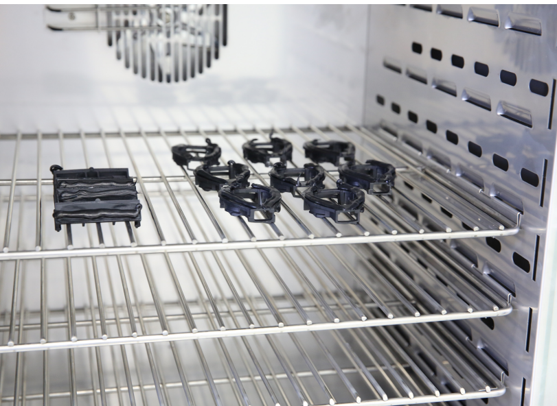
Mittels Alterungstests wird unter hohen Belastungen simuliert, wie sich die Verklebung langfristig verhält. © Bodo Möller Chemie GmbH
