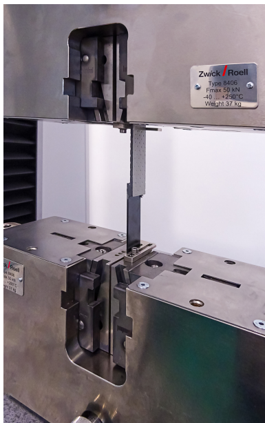
In Zugversuchen wird die Qualität der Verklebung geprüft. © Bodo Möller Chemie GmbH
