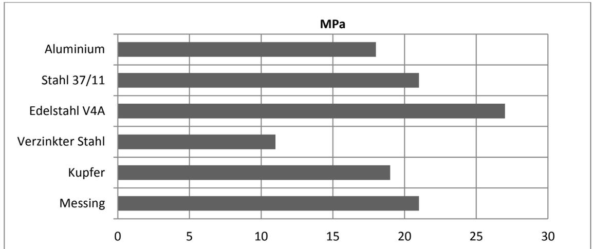
**Typische Mittelwerte der Zugscherfestigkeit verschiedener Kunststoffverklebungen (ISO 4587)**
